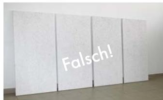
**Akustikplatten bei Montage und nachträglicher Einföhrung nie schräg gegen die Wand lehnen. Dies bewirkt eine Verwölbung der Platten – verwölbte Platten können nicht mehr eingebaut werden.**
